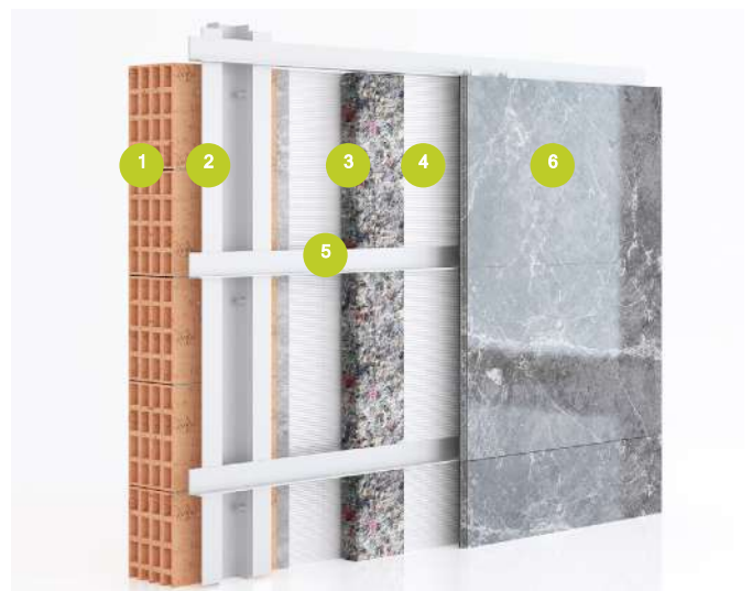
Posible instalación en fachada ventilada.
