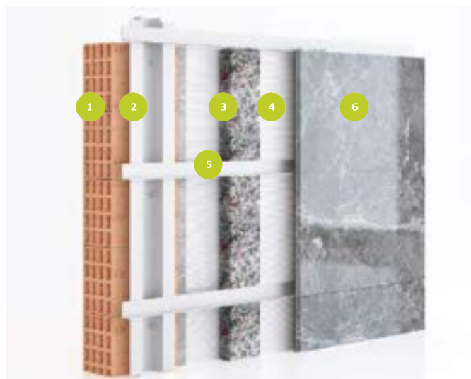
Mögliche Installation an belüfteter Fassade.
