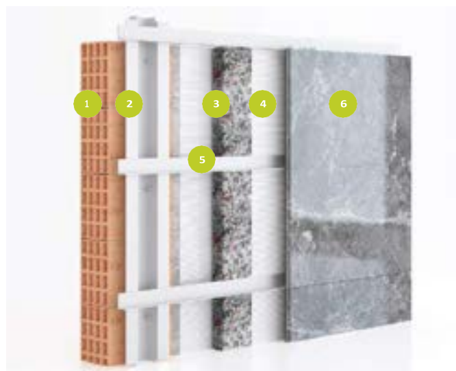
Mögliche Installation an belüfteter Fassade.
