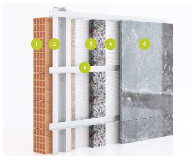
Posible instal·lació en fachada ventilada.
